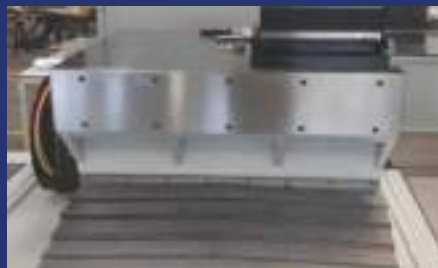
Contropunta con cannotto idraulico. Tailstock with hydraulic quill.
