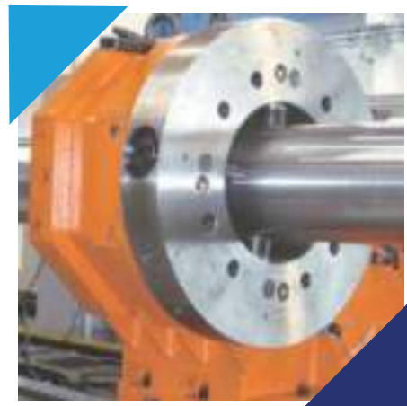
Lunetta folle con canotti interni. Timble steady with internal quill.
