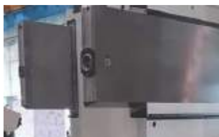
Torretta a disco esse orizzontale a 8/12 posizioni. Horizontal axis disk turret with 8/12 positions.
