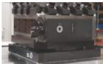
Torretta quadra ad asse verticale 4 posizioni per unità a tornire. Square turret with vertical axis with 4 positions for tools.
